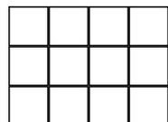
Não pode ser utilizado o assentamento com juntas tipo "tijolinho" em 50% da lateral da cerâmica.
