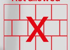
Não pode ser utilizado o assentamento com juntas tipo "tijolinho" em 50% da lateral da cerâmica.
