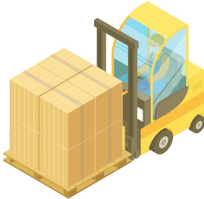
Sempre que possível, fazer a descarga com máquinas ou equipamentos que mantenham a paletização original dos produtos.
